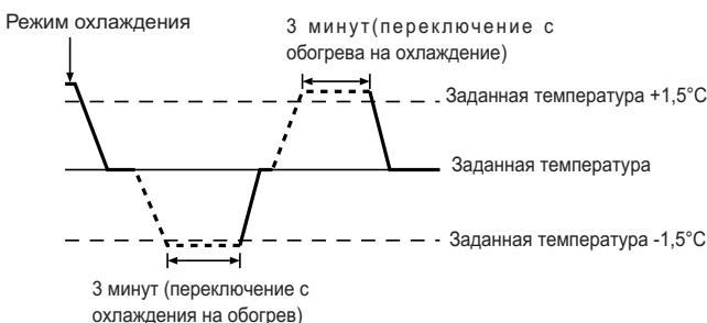
■ Так как температура в помещении регулируется автоматически для поддержания определенной эффективной температуры, работа в режиме охлаждения осуществляется на несколько градусов теплее, а работа в режиме обогрева на несколько градусов холоднее заданной температуры при достижении температуры (автоматическая экономия электроэнергии).
