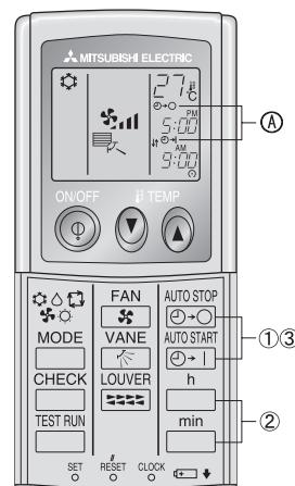
① Нажмите кнопку или кнопку (УСТАНОВКА ТАЙМЕРА - TIMER SET).
