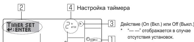
1. Убедитесь, что отображается стандартный экран управления, а также индикатор простого таймера (⑪).
