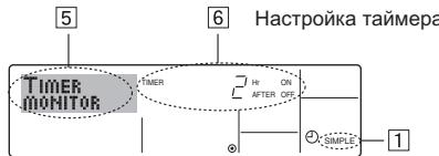
1. Убедитесь, что на экране отображается индикатор простого таймера (①).
