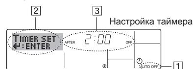
1. Убедитесь, что отображается стандартный экран управления и индикатор таймера отключения (Auto Off) (①).
